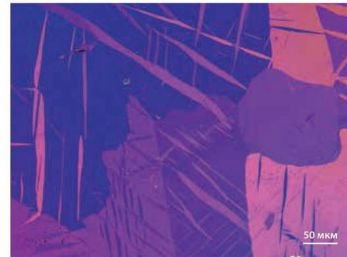
Цинк, отраженный свет, поляризационный контраст с лямбда-пластиной, объектив: EC Epiplan-NEOFLUAR 20x/0.50 HD DIC
