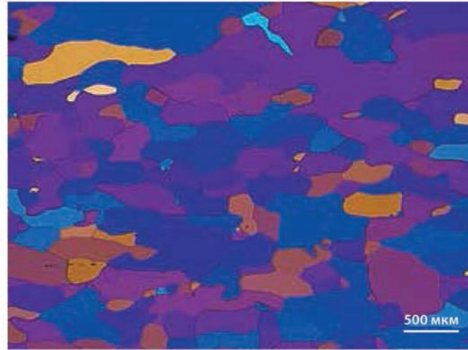
Алюминий, травленный по методу Баркера, отраженный свет, поляризационный контраст с лямбда-пластиной; объектив: EC Epiplan-NEOFLUAR 5x/0.13 HD DIC
