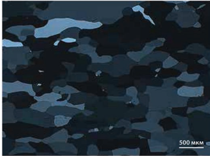
Алюминий, травленный по методу Баркера, отраженный свет, поляризационный контраст, объектив: EC Epiplan-NEOFLUAR 5x/0.13 HD DIC
